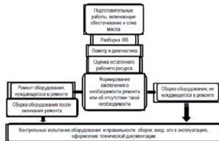
Рисунок 1 – Общая технологическая схема регламентного обслуживания высоковольтных выключателей
