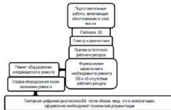
Рисунок 3 – Вариант № 2 технологической схемы регламентного обслуживания с использованием цифровой диагностики до и после ремонта
