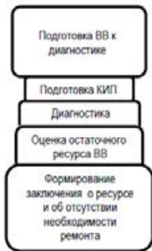
Рисунок 2 – Вариант № 1 технологической схемы регламентного обслуживания ВВ с использованием цифровой диагностики без разборки диагностируемого оборудования
