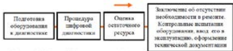
Рисунок 2 – Вариант № 1 технологической схемы регламентного обслуживания с использованием цифровой безразборной диагностики
