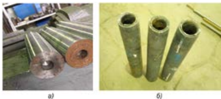
Рисунок 4 – Заготовки: а) – с зацентровкой до прошивки; б) – после прошивки.
