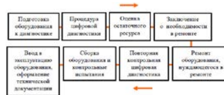
Рисунок 3 – Вариант № 2 технологической схемы регламентного обслуживания с использованием цифровой диагностики до и после ремонта
